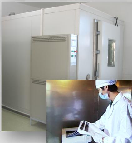
Тесты в климатической камере: Проверка характеристик при экстремально высокой и низкой температуре/влажности.
