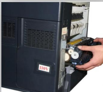
100% фьюзеров CET перед упаковкой проверяется установкой в принтер и печатью на бумаге различной плотности. 10% случайно выбранных готовых фьюзеров возвращается в лабораторию для полной проверки.
